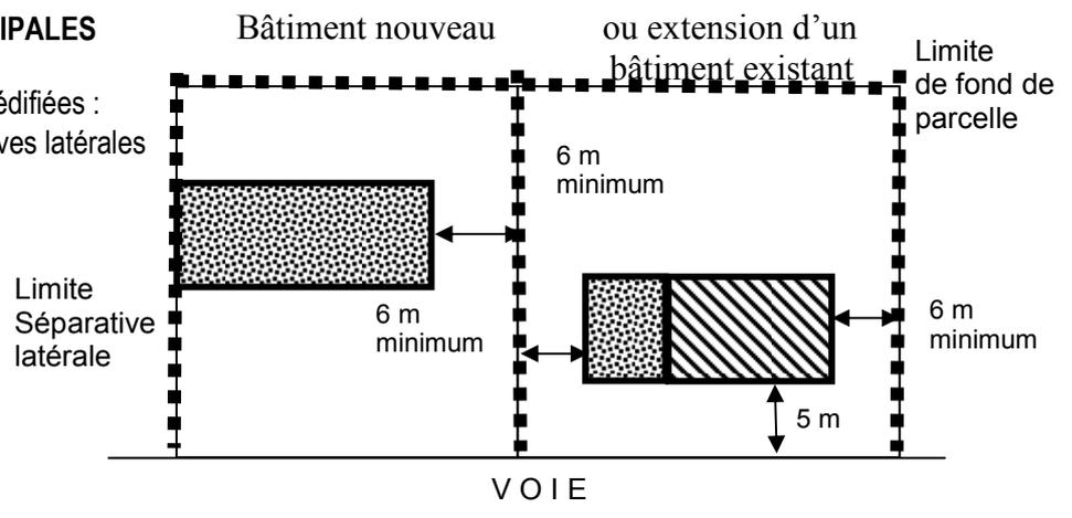
Les façades non contiguës aux limites séparatives doivent être implantées à une distance au moins égale à la moitié de la hauteur du bâtiment mesurée à l'égout du toit principal sans pouvoir être inférieure à 6 m.
